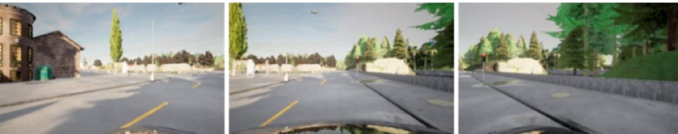
Fig. 2: Imagens das três câmeras frontais localizadas na parte esquerda, central e direita do veículo, respectivamente. Elas foram tiradas no ambiente de simulação CARLA. Cada câmera produz uma imagem RGB com 144 pixels de altura e 256 pixels de largura.
