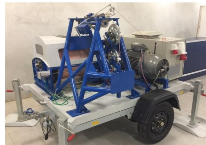
Fig. 8: Unidade de solo de 12 kW desenvolvida no projeto UFSCkite. Fonte: arquivo UFSCkite.
