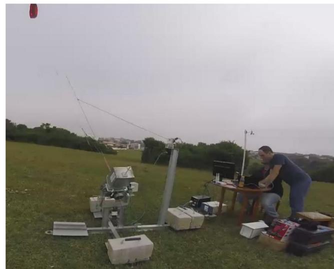
Fig. 4: Protótipo para validação do controle de voo em teste de campo. Fonte: arquivo UFSCkite.
